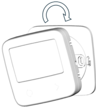
Kuva 1. Huoneistonäytön asentaminen seinätelineeseen
