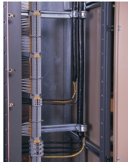
KUVA: Kojekaisto varustetaan tarvittavilla kaapelikuiluilla, joissa on runsaasti C-kiskoja kaapelikiinnikkeitä varten. Kenttakaapelien asennus kojeistoon on helppoa, sillä asennusta varten on riittävästi kytkentätilaa myös lähtöyksiköissä.
