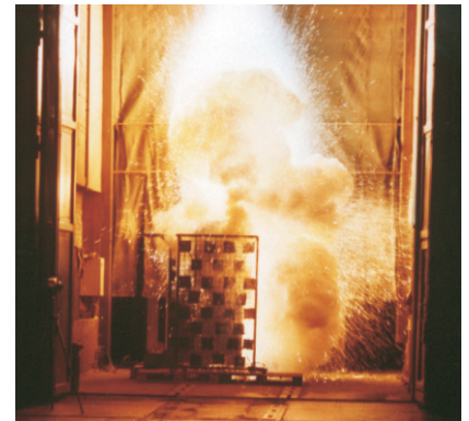
KUVA: NorPower 5000 on valokaari-koestettu laboratoriossa
